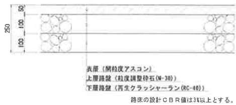
アスファルト舗装工(D) (駐車場)
