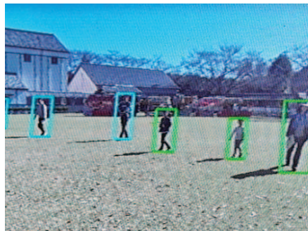
車載カメラで周囲の歩行者を認識している様子
