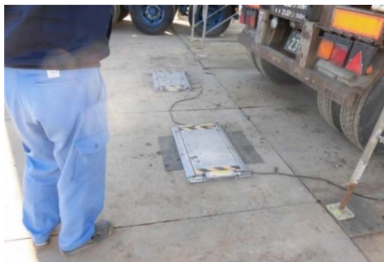
台貫を使用した重量の計量 (きぬアクアステーション)
