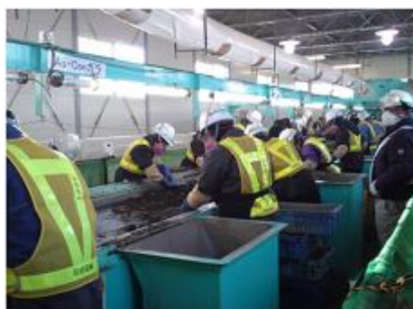
仮施設設内の手選別工程 （宮城県岩沼市，平成25年2月）
