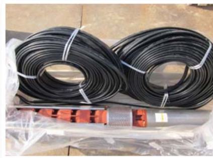
更新後の深井戸用水中ポンプ
