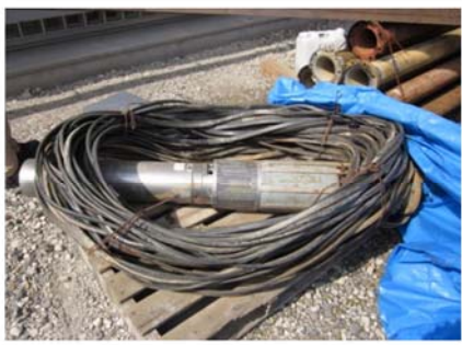
更新前の深井戸用水中ポンプ
